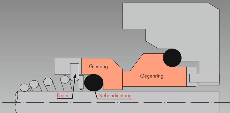
Die gleitenden Bauteile – Gegenring & Gleitring – werden mit ihren Laufflächen gegeneinander im Maschinengehäuse eingebaut. Während der Gegenring statisch eingebaut ist, bewegt sich der Gleitring mit der
